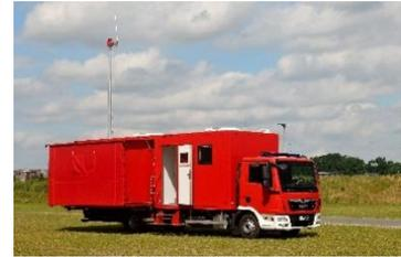
Ausgestattet ist er u. a. mit aktueller Computertechnologie, Satellitentelefon und aufgrund seiner ausklappbaren Seitenteile mit einem 20qm großen Besprechungsraum für 10 Arbeitsplätze.
